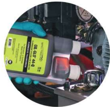
PASO 1 AÑADIR/INYECTAR COLORANTE FLUORECENTE EN EL SISTEMA
