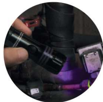
PASO 2 UTILIZAR LÁMPARA ULTRAVIOLETA PARA INSPECCIONAR FUGAS
